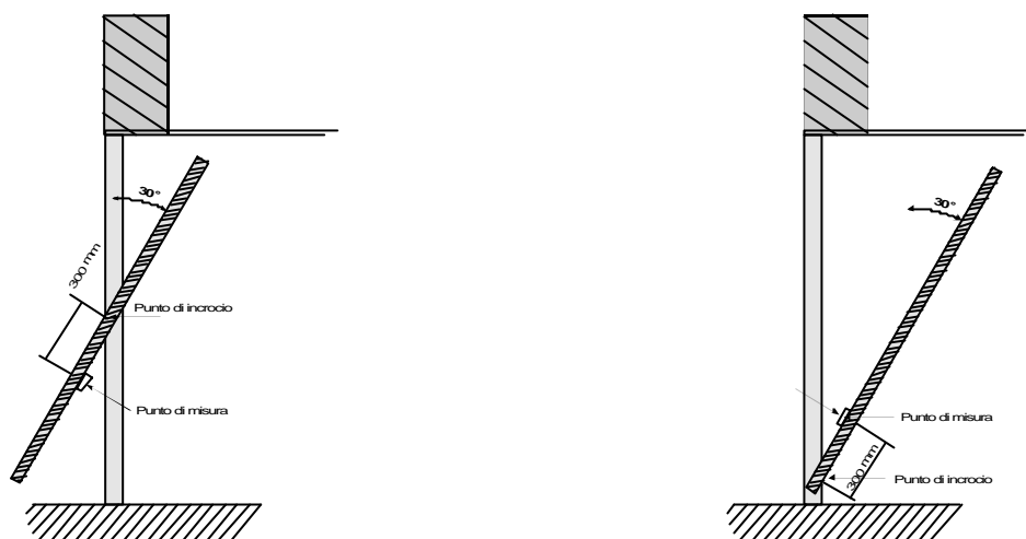
Figura 9: Punti di misura sul bordo secondario di una porta basculante
